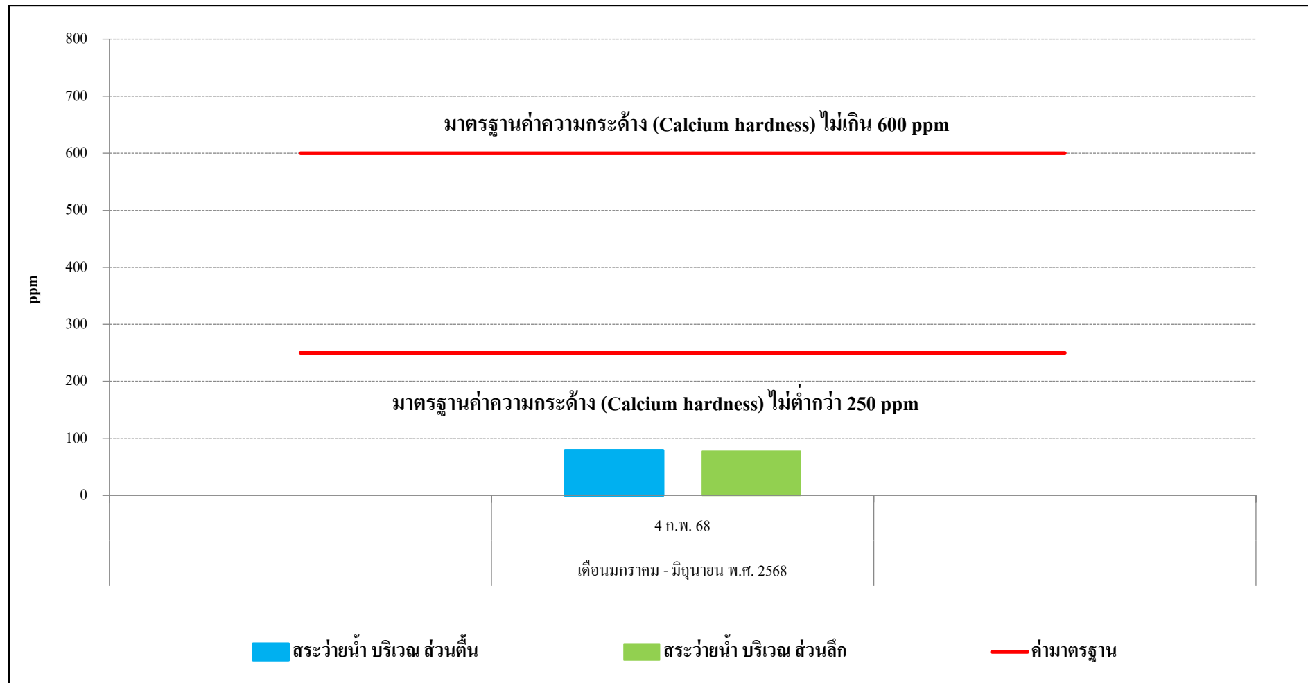
รูปที่ 3.3-7 กราฟสรุปผลการตรวจวัดความกระด้าง (Calcium hardness) ในสระว่ายน้ำ
